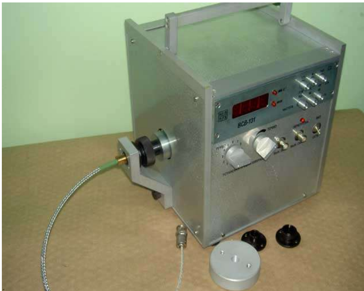
Вибростенд переносной ВСВ-131. Общий вид.
