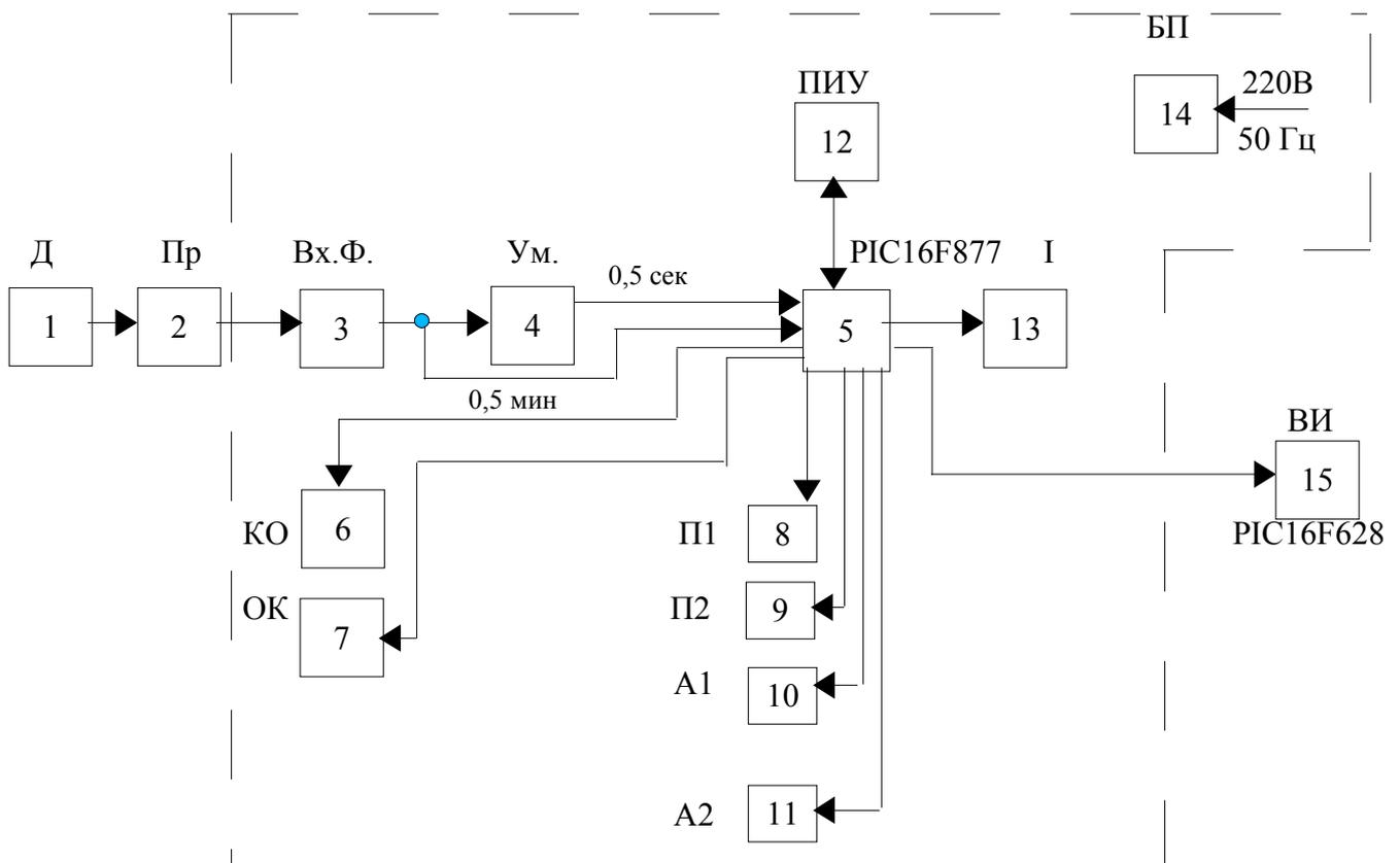
Рис. 1 Структурная схема тахометра ИП-114/2.
