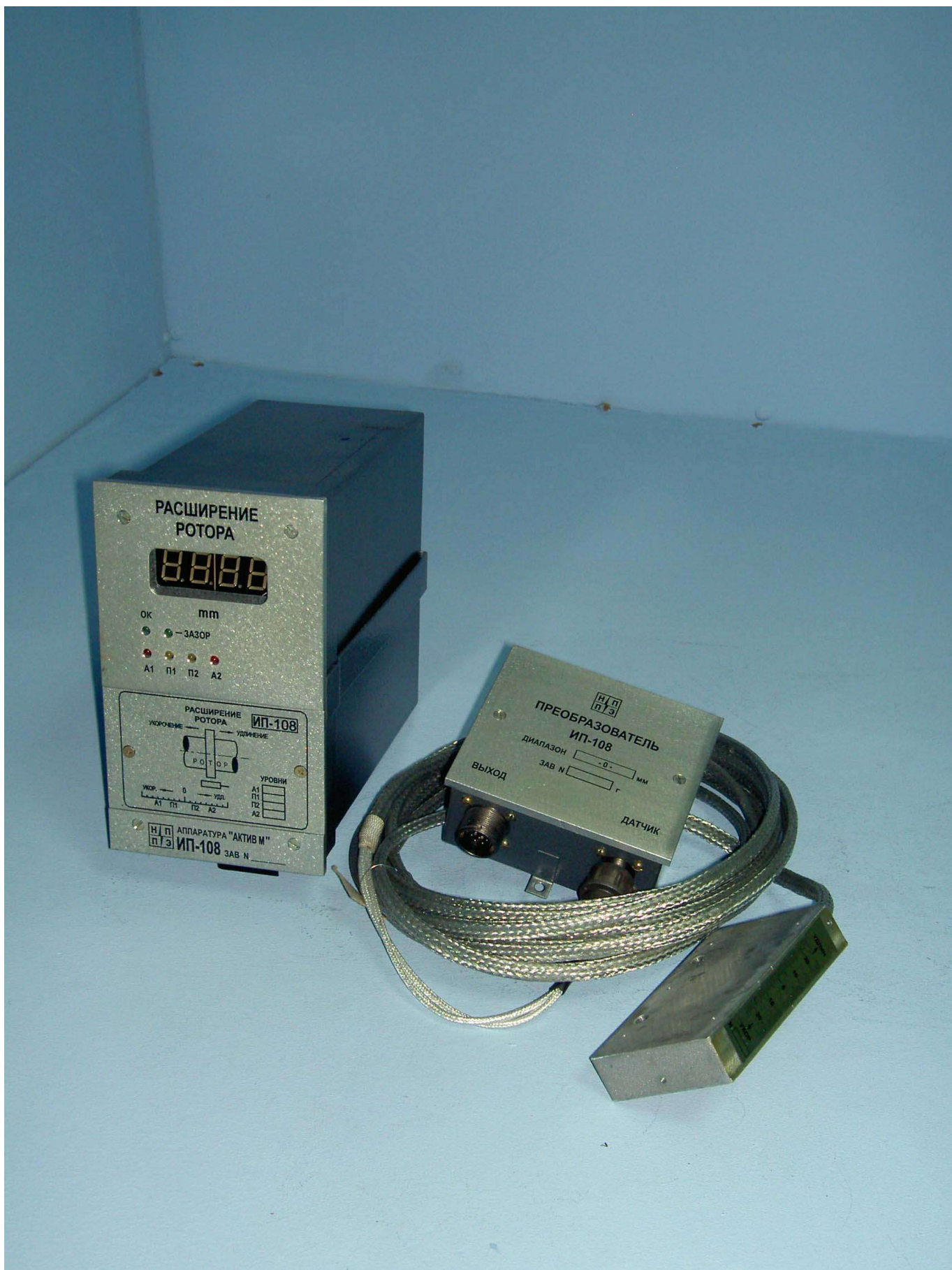
Внешний вид устройства ИП-108.
